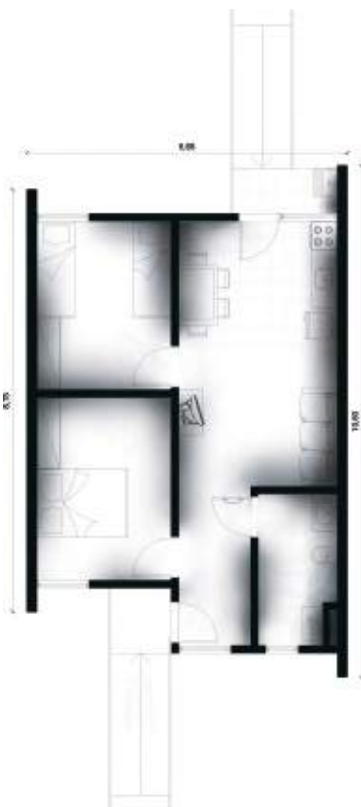
Figura 2 - Planta baixa da casa térrea adaptada a PcD. Fonte: Projeto de Extensão Arquitetura e Comunidade, 2011.
