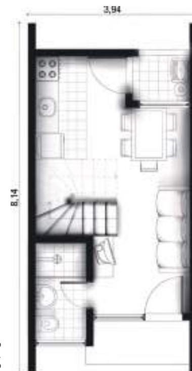
Figura 3 - Planta baixa do sobrado de 2 dormitórios, térreo. Fonte: Projeto de Extensão Arquitetura e Comunidade, 2011.
