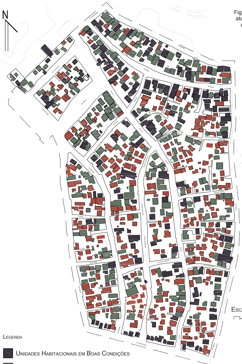
Figura 3 - Material construtivo das unidades habitacionais atuais. Fonte: PROJETO DE EXTENSÃO ARQUITETURA E COMUNIDADE, 2011
